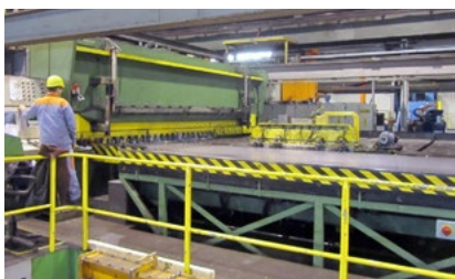
Линия автоматической резки на заводе в Дикирше
